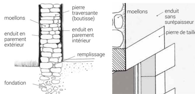
Coupe schématique d'un mur en moellons
