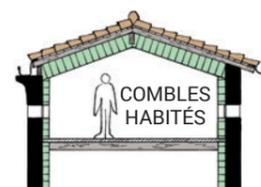
Combles aménagés : isolant en rampant.
