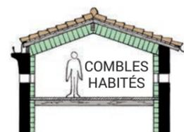
Combles aménagés : isolant en rampant.
