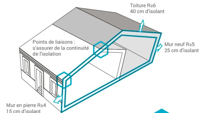
R : coefficient de résistance thermique en  $(\text{m}^2\cdot\text{K})/\text{W}$
