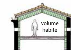
isolation sous toiture
